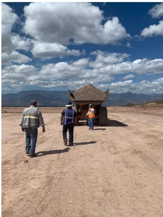
**Ilustración 38: Prueba de carga en los carriles AZ-2,3,4**
