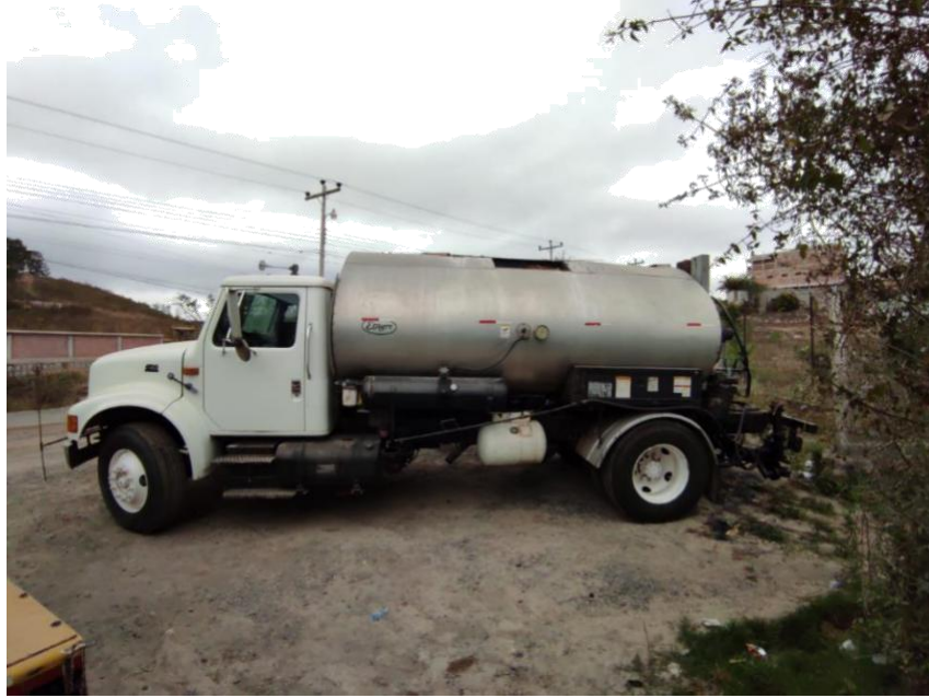
Ilustración 15. Camión irrigador de asfalto
