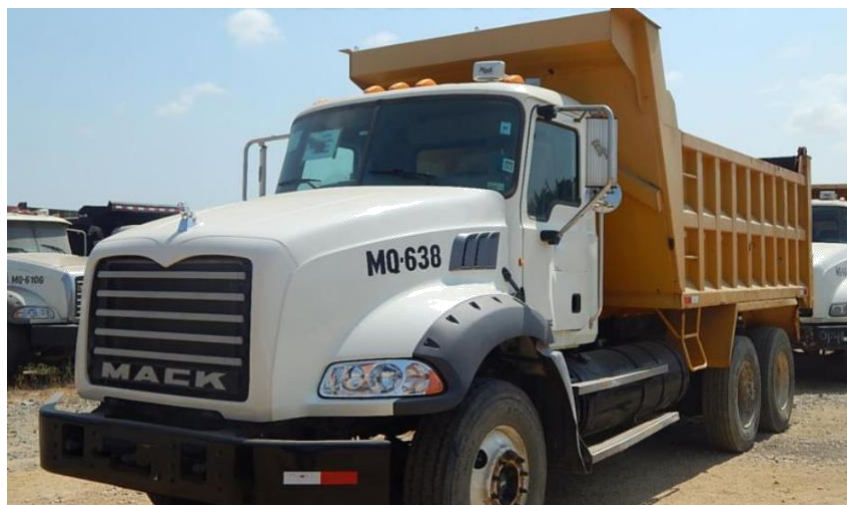
Ilustración 12. Camión volqueta para transporte horizontal de material
