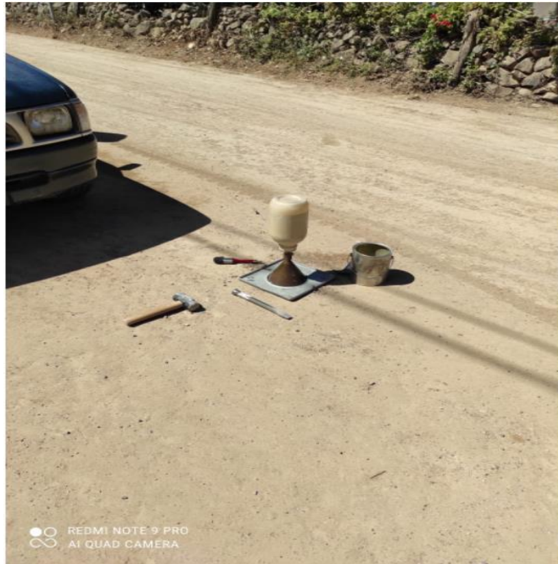
Ilustración 20. Prueba de densidad in situ estación 0+385
