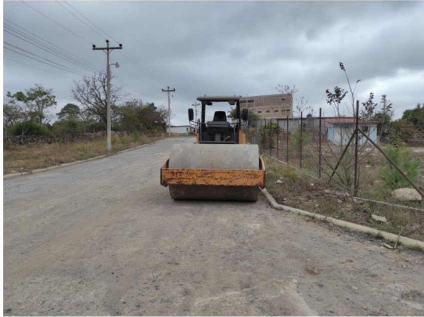
Ilustración 13. Vibro compactadora de rodillo para compactación de terreno
