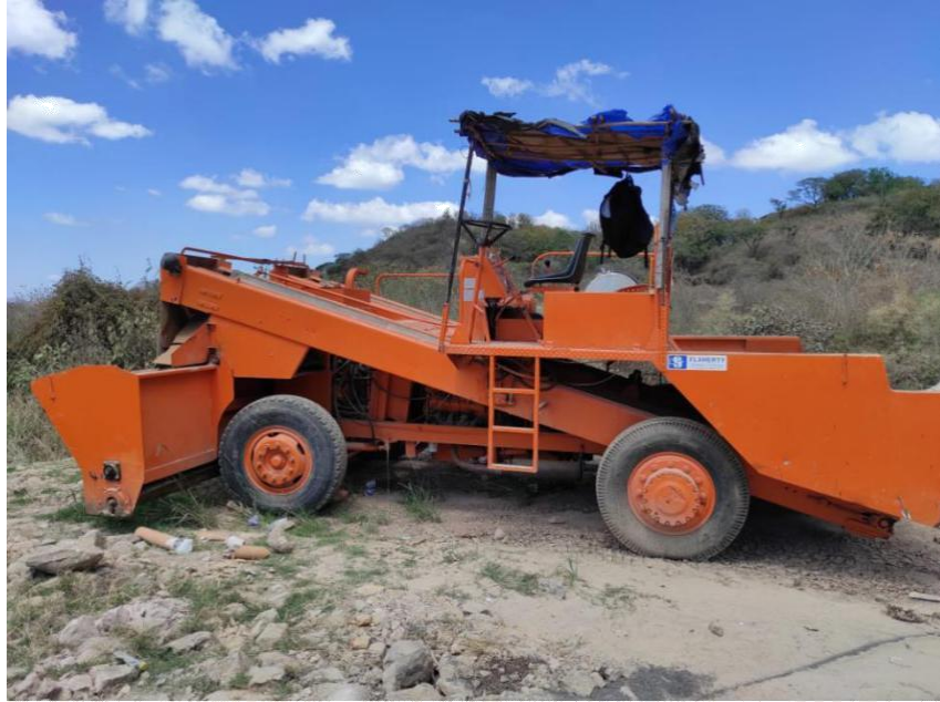
Ilustración 14. Esparcidora de agregado
