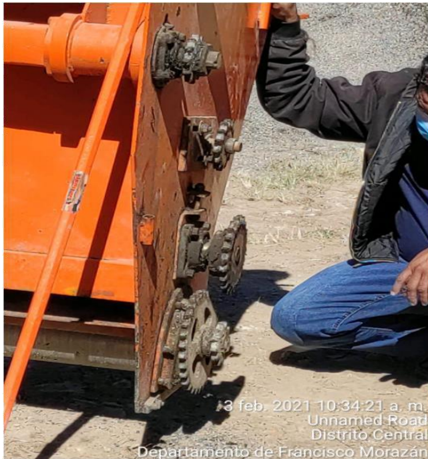
Ilustración 24. Desperfecto mecánico en la esparcidora de agregado
