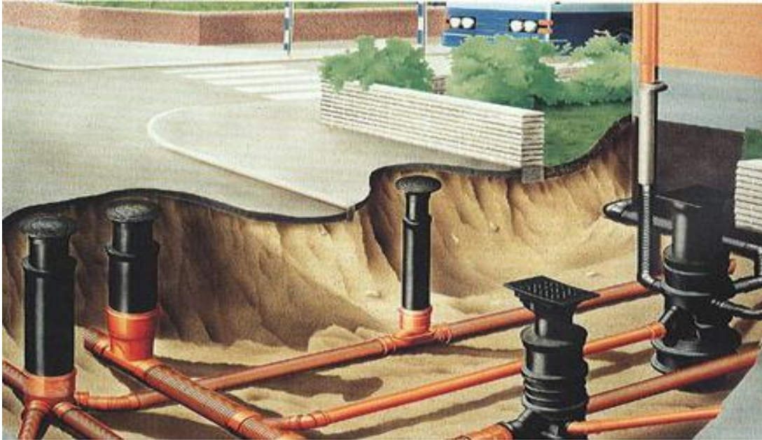
Ilustración 19 Sistema de alcantarillado Sanitario
