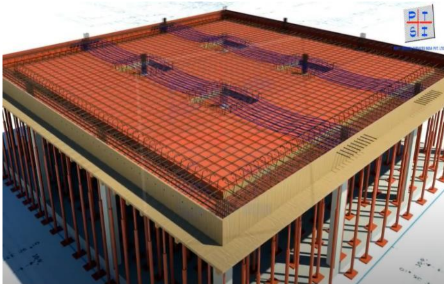
Ilustración 30 Colocación de los Cables como Vigas del Sistema
