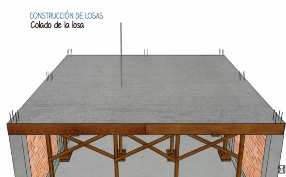
Ilustración 10 Colado del Concreto
