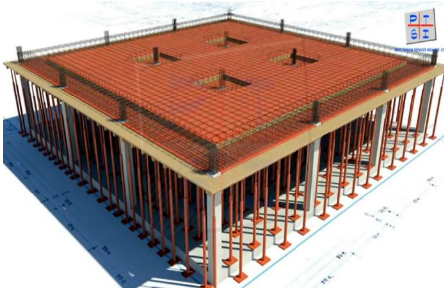
Ilustración 27 Armado del Acero
