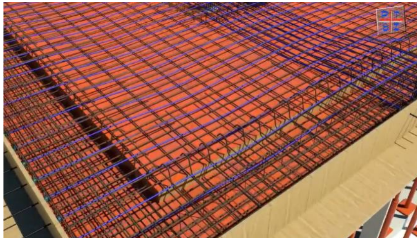
Ilustración 32 Cableado de la Losa
