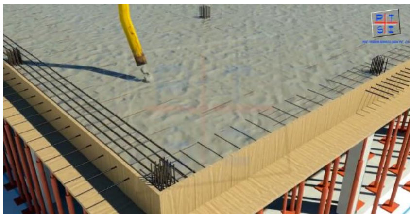
Ilustración 33 Colado del Concreto
