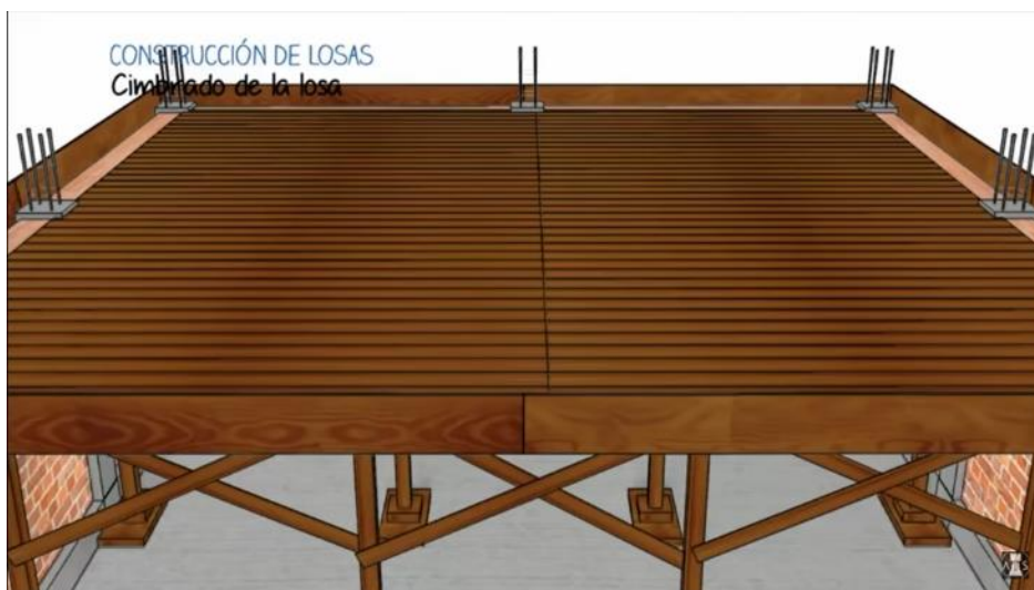
Ilustración 8 Encofrado de la Losa
