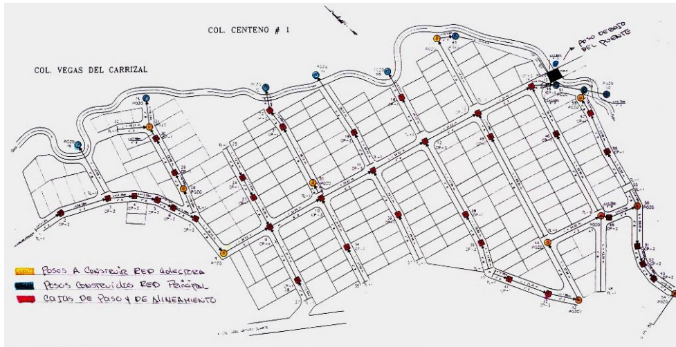
Ilustración 11: Esquema de una red de alcantarillado simplificado
