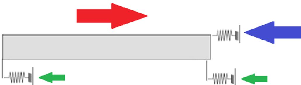
**Ilustración 44 Representación de los valores de fuerza de frenado, fuerza de tensión en la losa y rigidez en los apoyos**
