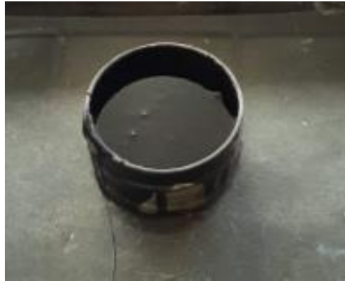
Ilustración 12 Cemento asfáltico utilizado
