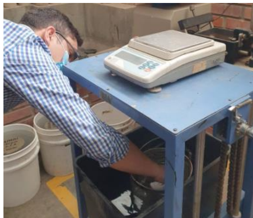
Ilustración 21 Peso sumergido de pastillas compactadas
