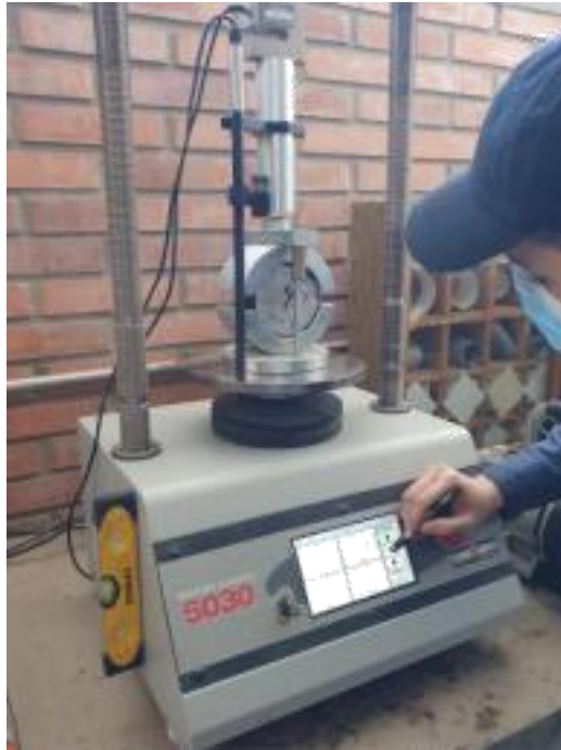
Ilustración 22 Aplicación de carga en máquina Marshall
