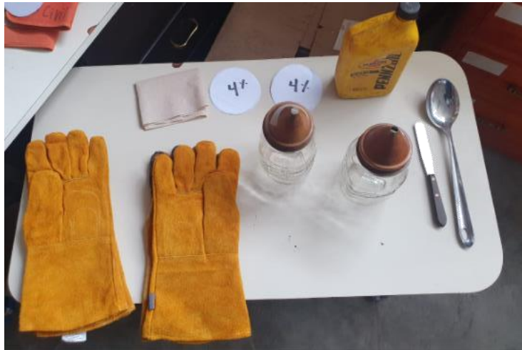
Ilustración 7 Picnómetro y equipo de protección utilizado en ensayo Marshall
