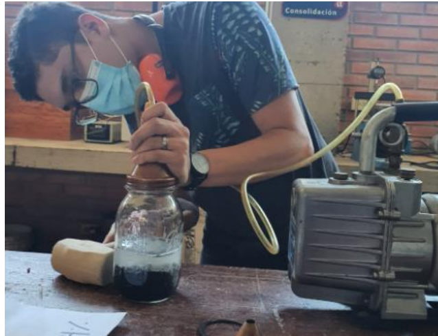
Ilustración 20 Retirado de vacíos en mezcla suelta
