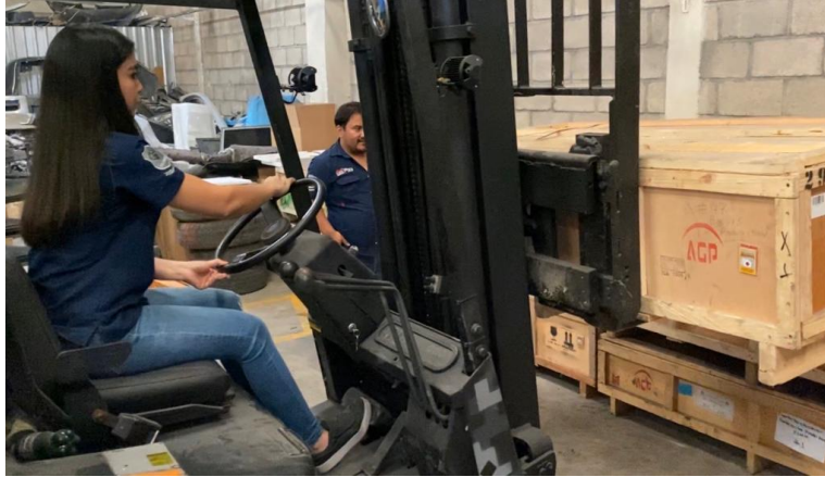
Ilustración 29- Colocación de cajas con montacargas
