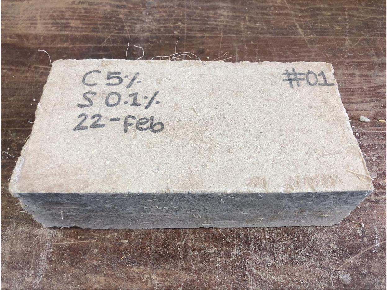
**Ilustración 28. Ladrillo de cemento 5% + fibra de sisal 0.1%**
