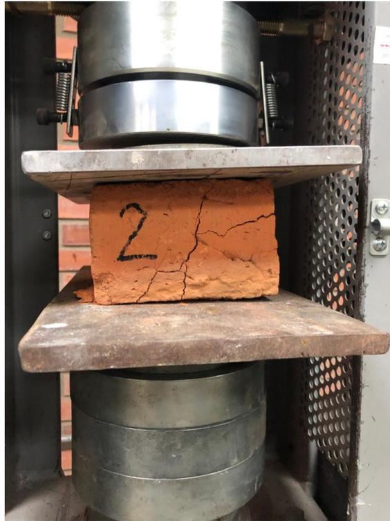
**Ilustración 16. Ensayo de compresión en ladrillo tradicional de arcilla**
