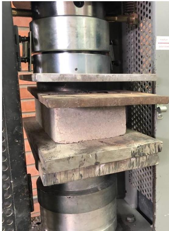
**Ilustración 15. Ensayo de compresión en ladrillo ecológico**
