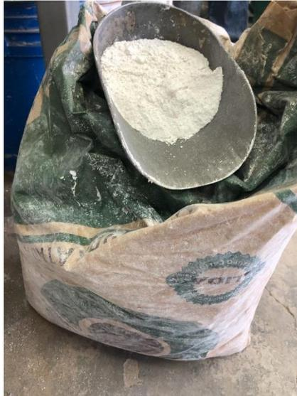
**Ilustración 7. Cal hidratada**
