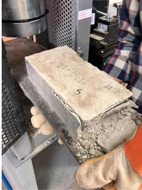
**Ilustración 21. Ladrillo ecológico de cal después del ensayo de compresión**
