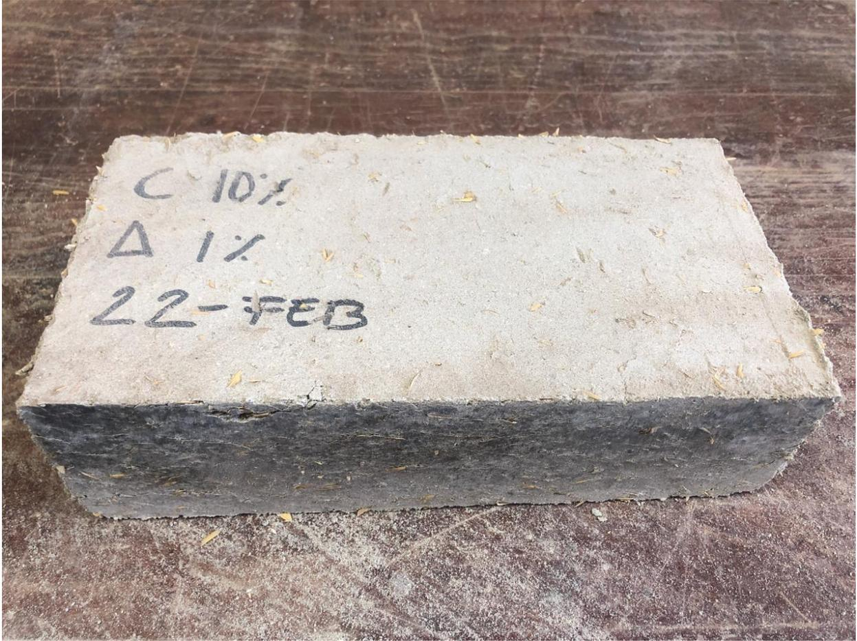
**Ilustración 27. Ladrillo de cemento 10% + casc. de arroz 1%**
