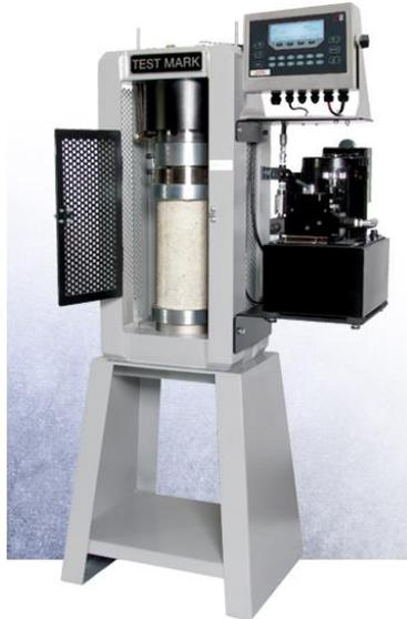
**Ilustración 5. Máquina de compresión**
