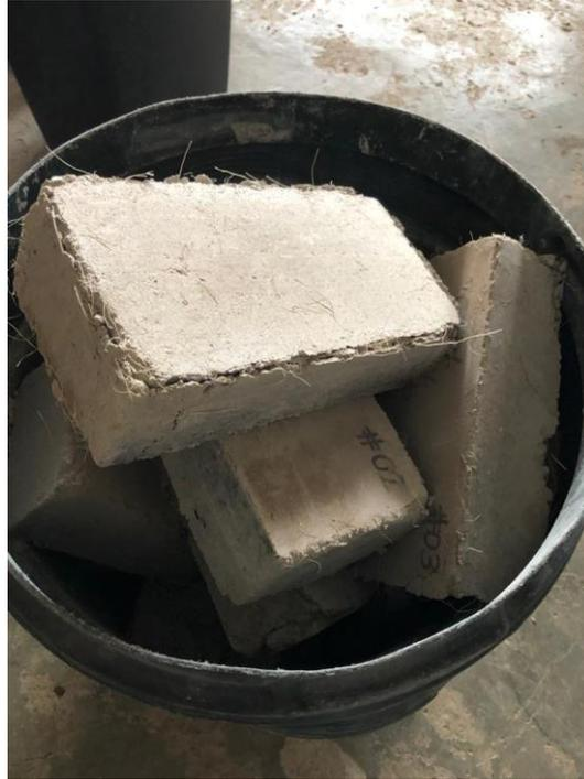
**Ilustración 20. Ladrillos ecológicos después del ensayo de compresión**
