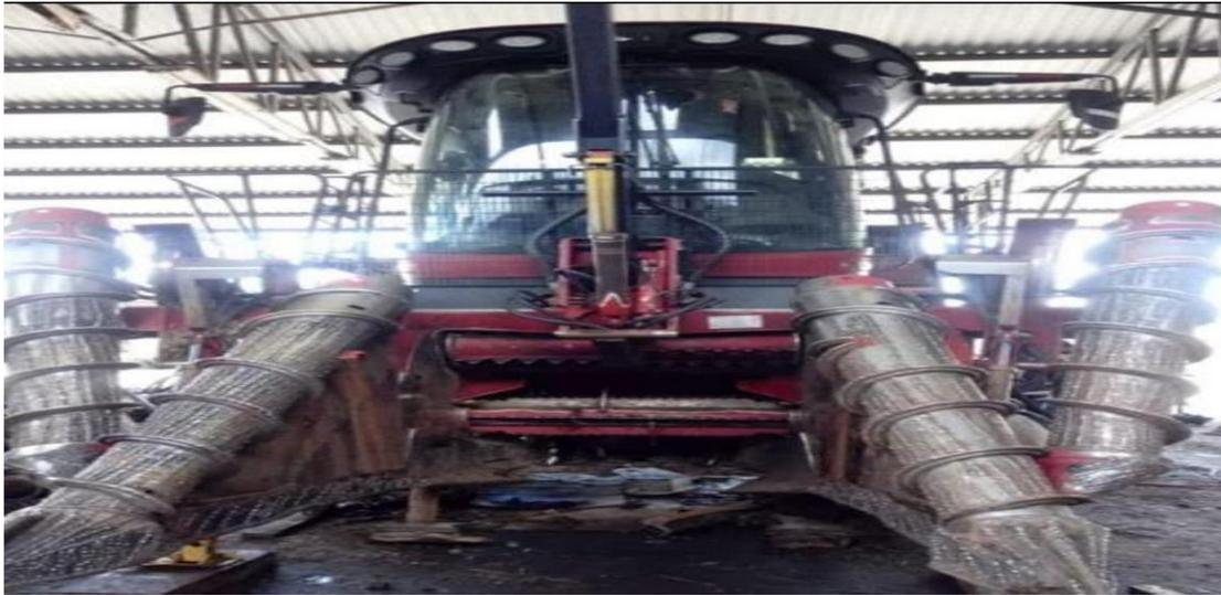
Ilustración 4, Cosechadora de caña con corte mecanizado
