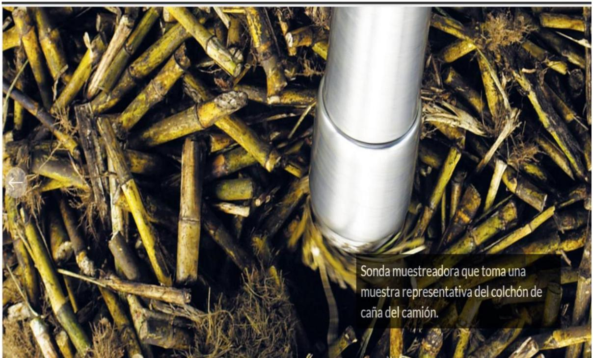
Ilustración 10, Toma de muestra para determinar la calidad de la caña
