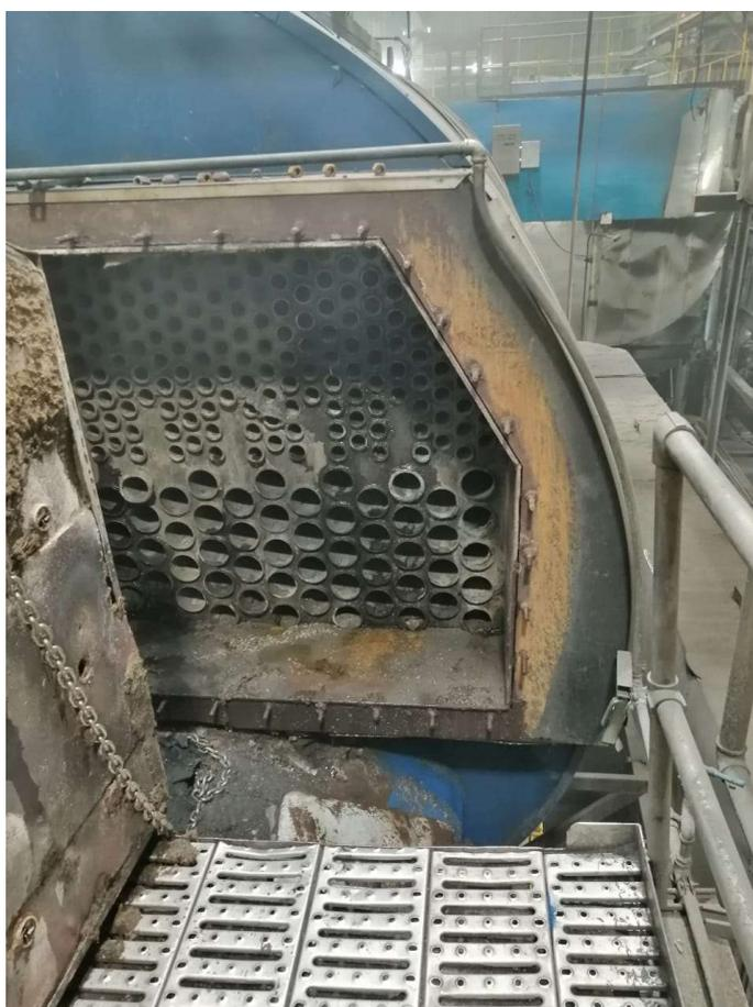
*Nota:* En la imagen podemos observar el sistema de piro tubos el cual está en mal estado por fisuras.
