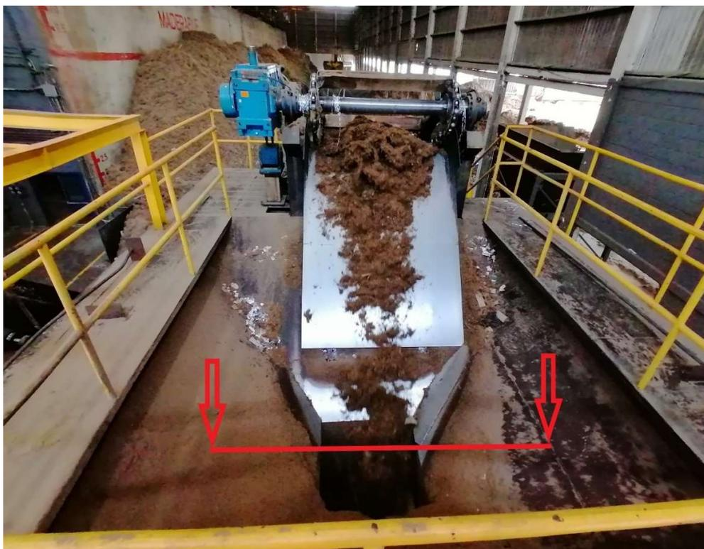
*Nota:* En la imagen se puede observar la posible ubicación del sensor para evitar bóveda.
