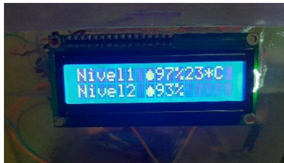
Figura 8.18 Pantalla LCD mostrando niveles de humedad y temperatura (Elaboración propia, 2021)
