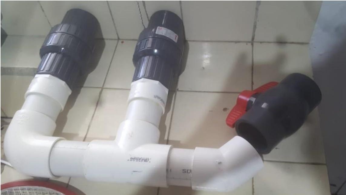
Nota. Para el armado del cuerpo del ariete se utilizaron piezas de PVC de dos pulgadas de diámetro constituida por dos válvulas antirretorno, una válvula de cierre i empalmadas con codos de ángulo 45 y 90 grados, sujetas por pegamento, Elaboración propia (2021).
