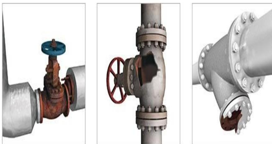
*Nota.* Efectos negativos que produce el golpe de ariete donde se observa por el exceso de presión la tubería colapsa agrietando la estructura metálica, usualmente producida por el cierre brusco de del paso del fluido en movimiento, adaptado por (TLV, s. f.)
