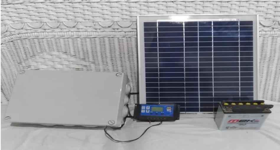
Nota. el sistema de alimentación esta constituido por un panel solar de 20 w, una batería de 12v 7,un controlador solar PWM y un gabinete para instalar el sistema de control, Elaboración propia (2021).
