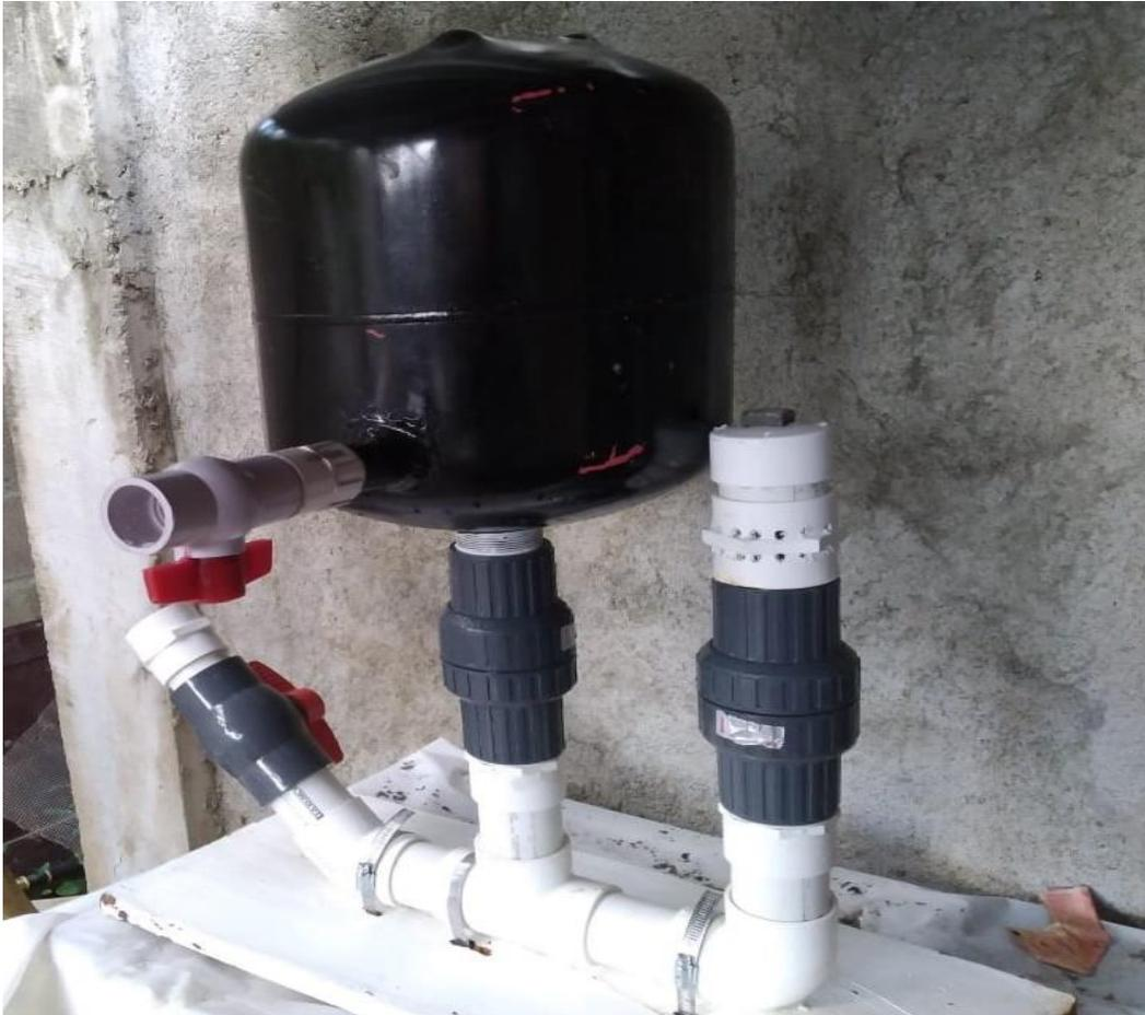
*Nota.* El ariete hidráulico se le añade un tanque modificado para que se adapte a la entrada de dos pulgadas en la salida de la válvula, el cual se utilizara para comprimir el aire y expulsar con presión el agua, Elaboración propia (2021).
