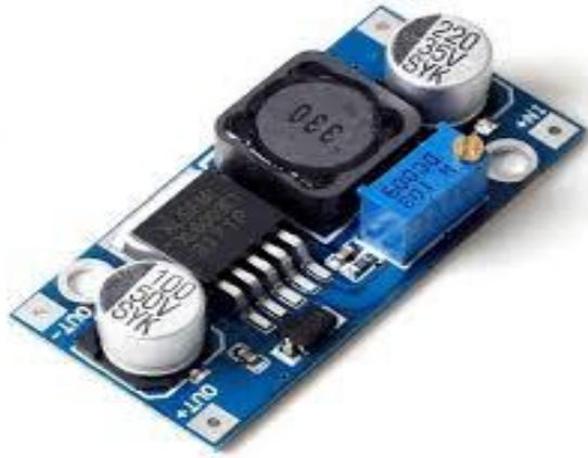
*Nota.* Controlador regulable de tensión para alimentación de dispositivos que trabajen a 9v, adaptado por .Mecafenix, (2017)
