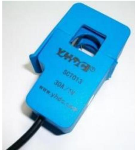
Figura 4.6.7 Sensor de corriente de efecto hall SCT013. Fuente: http://www.diverteka.com
