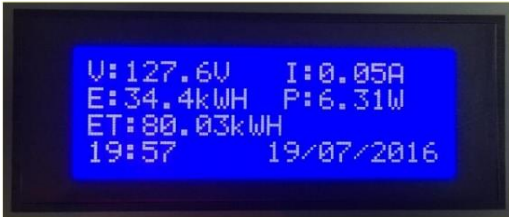
Figura 7.1.11 LCD indicando voltaje, corriente, potencia, energía acumulada, hora, fecha. Fuente: (Idrovo & Israel, 2016)
