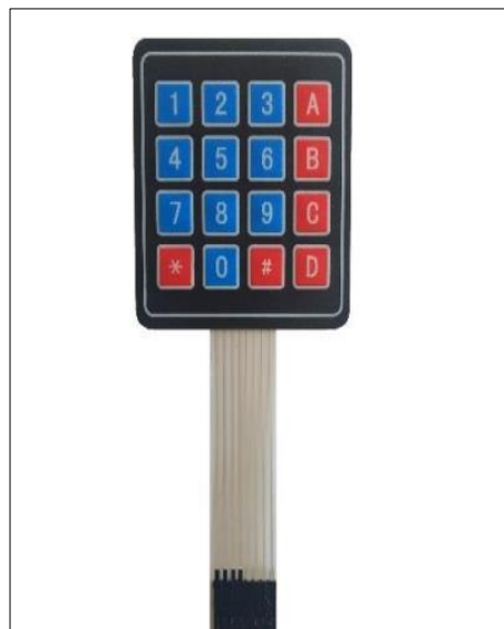
Figura 4.6 Modelo de un teclado matricial. Fuente (Joel, 2019, pág. 12)
