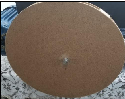
Figura 8.18 Prototipo de turbina fabricado de madera (PROPIA, 2021)
