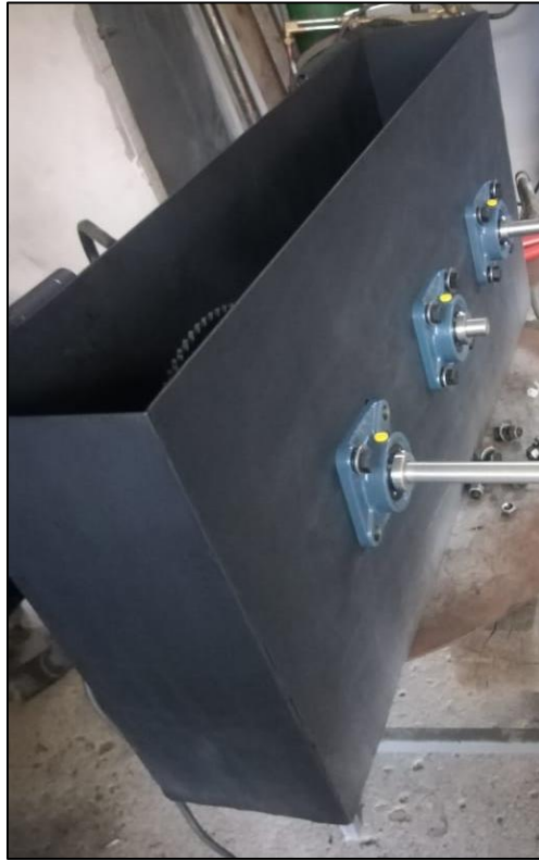
Figura 8.12 Caja de transmisión de prototipo de turbina. (PROPIA, 2021)
