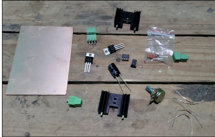
Figura 8.13 Componentes para fabricación de tarjeta inversora. (PROPIA, 2021)
