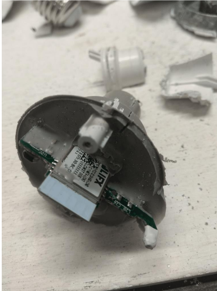
Ilustración 4.8 Desensamble de Bombillo LIFX (LimitedResults,2019)
