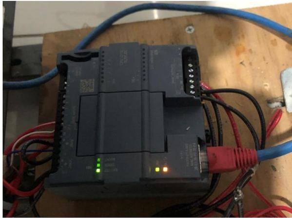
*Figura 8.14* PLC 1200 siemens (Elaboración, propia, 2021)
