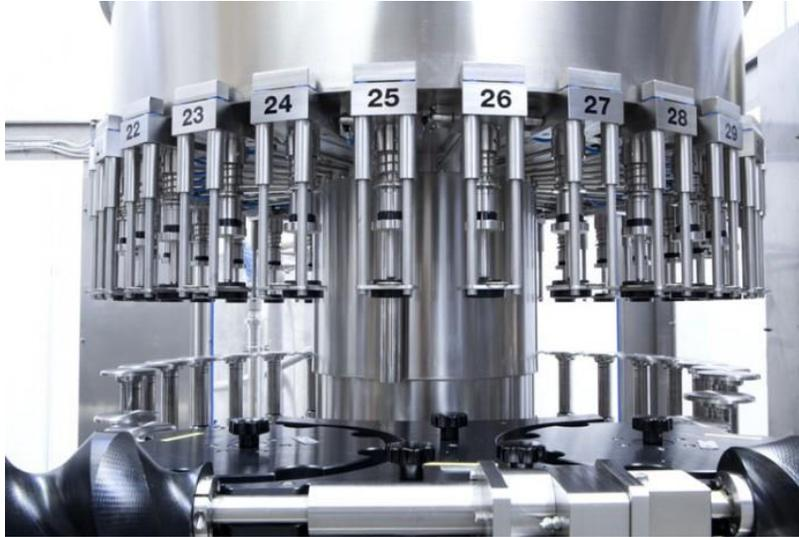
Figura 4.7 Maquina de llenado por gravedad a nivel (Dellatoffola, s.f.)
