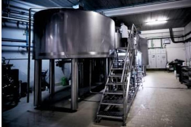
*Figura 4.3* Equipo de elaboración de cerveza de 8.000 litros por cocción (Redacción, 2020)
