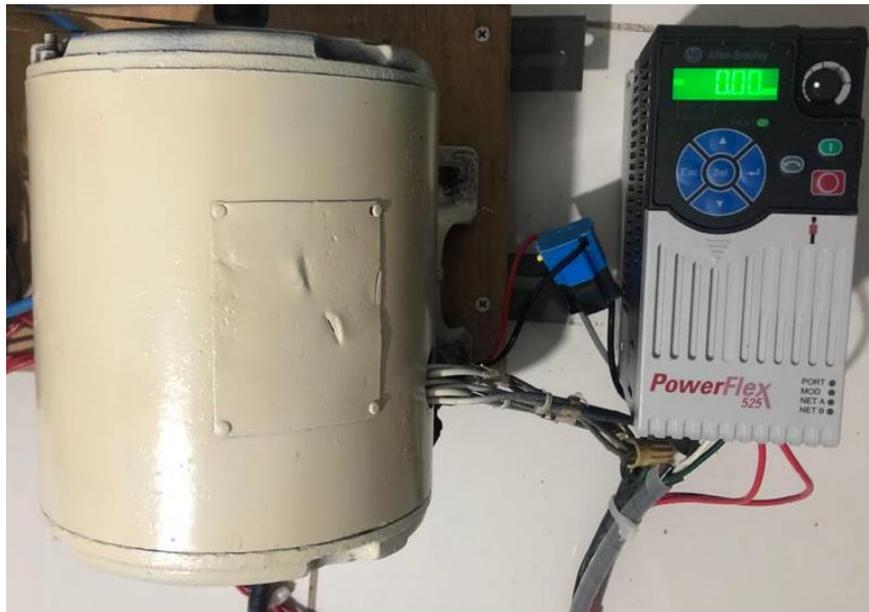
Figura 8.18 Control de motor por medio de un variador de frecuencia (Elaboración propia, 2021)
