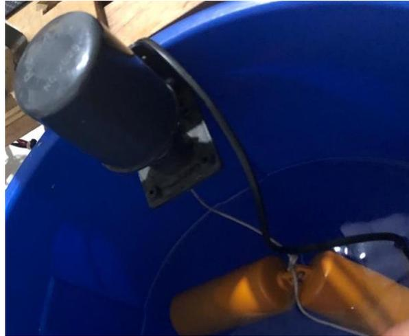
Figura 8.17 Sensor sumergible instalado en el tanque (Elaboración propia, 2021)
