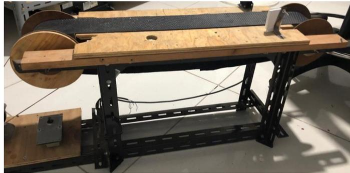
Figura 8.12 Base, rodillos y banda del sistema (Elaboración propia, 2021)
