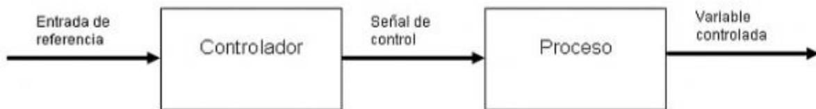
Figura 4.8 Diagrama de sistemas de lazo abierto. (Blogspot, Ejemplo sencillo, 2019)
