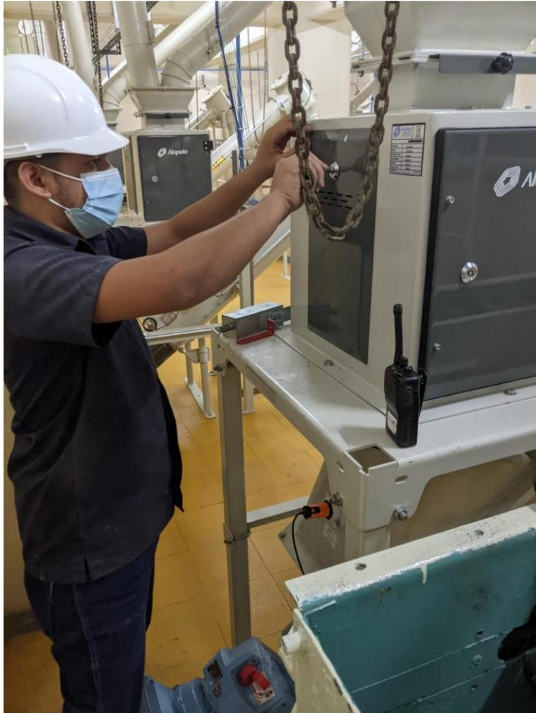
*Ilustración 10 Operario realizando calibraciónl con masa de 3kg*
