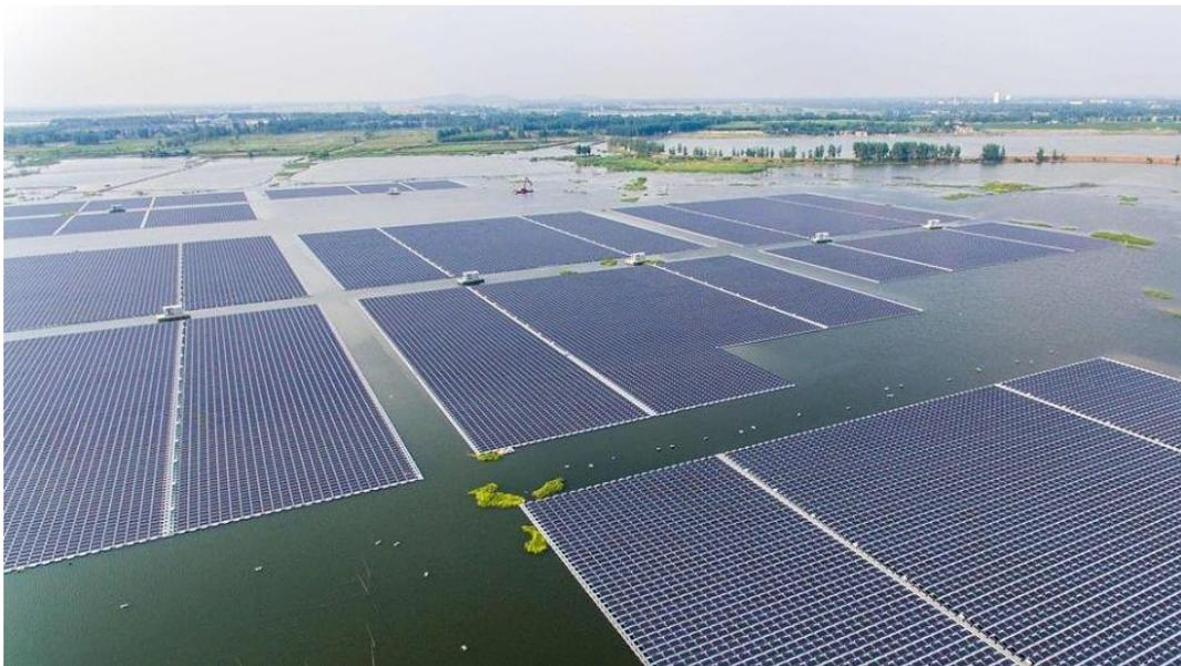
**Ilustración 10. Planta fotovoltaica flotante de la ciudad de Huainan**
