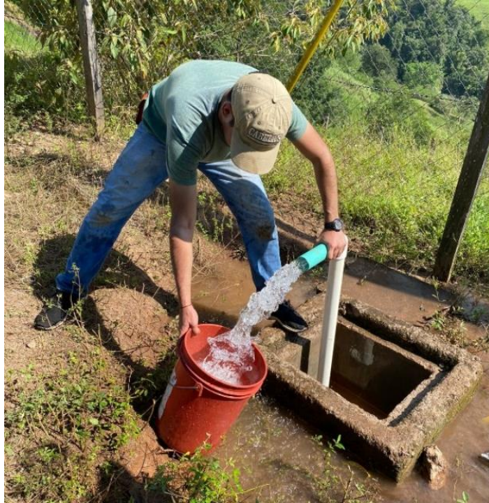
Ilustración 34-Medición del tiempo de llenado de un volumen conocido
