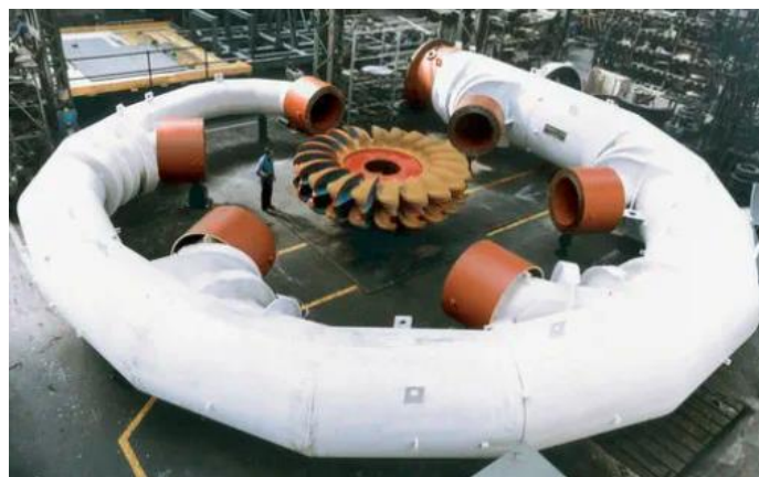
Ilustración 17-Distribuidor de turbina Pelton
