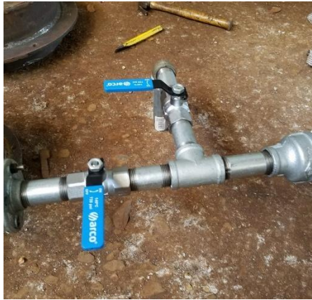
Ilustración 46-Sistema de admisión de la microturbina
