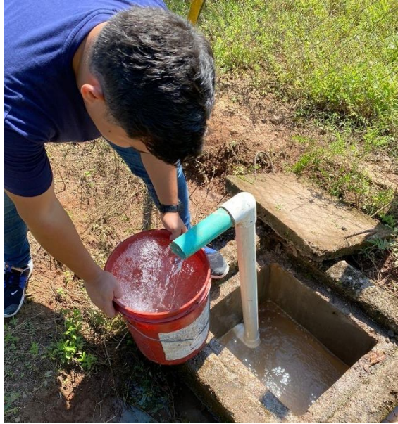
Ilustración 29 - Medición del caudal por medio del método volumétrico
