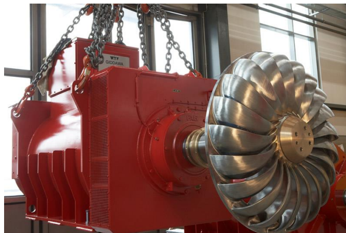
Ilustración 21-Turbina Turgo de eje horizontal
