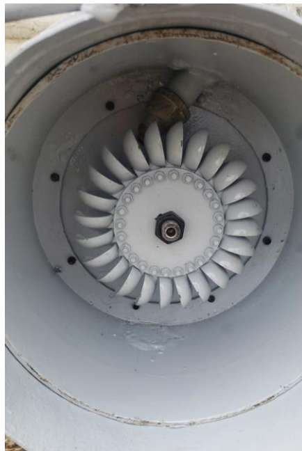
Ilustración 45-Rodete tipo Turgo de la microturbina
