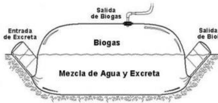
**Ilustración 12 Biodigestor tipo tubular**
