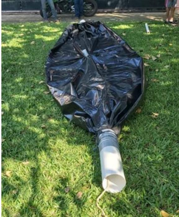
**Ilustración 16 Manga Tubular para biodigestor de flujo continuo**
