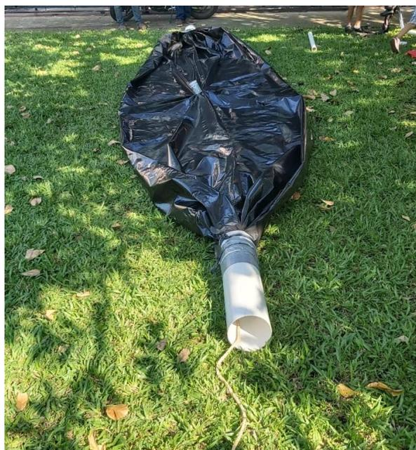
**Ilustración 29 Reactor con flange y tubería de entrada y salida instalada**
