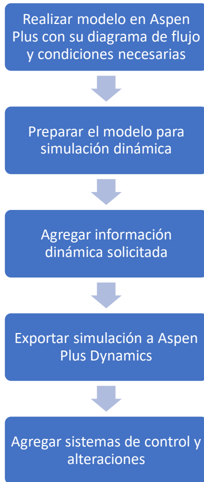
Ilustración 21 - Proceso para convertir una simulación estática a una simulación dinámica desde Aspen Plus a Aspen Plus Dynamics.
