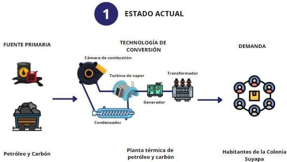
**Ilustración 32. Estado actual para generación de energía eléctrica**
