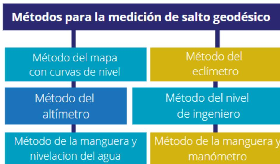
**Ilustración 26. Métodos para la medición del salto de agua o geodésico**
