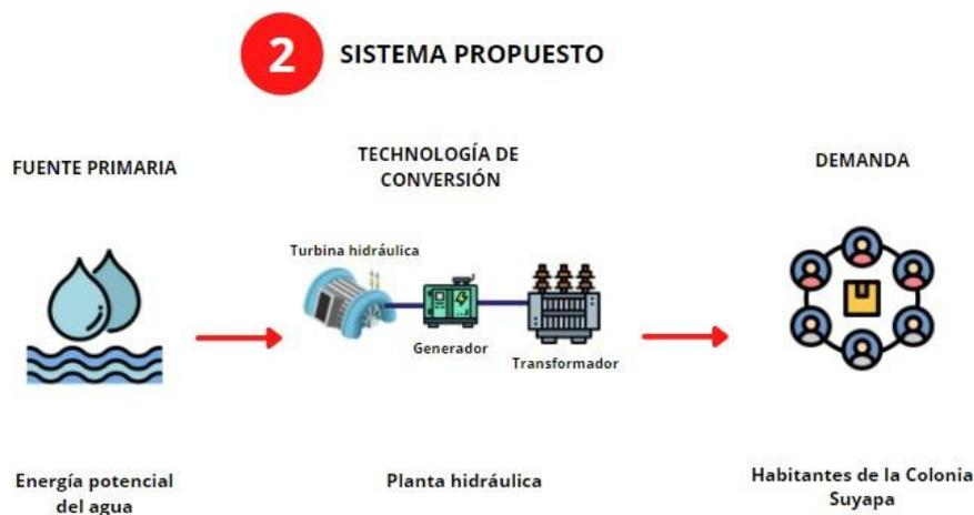
**Ilustración 33. Tecnología propuesta para la generación de energía eléctrica**
