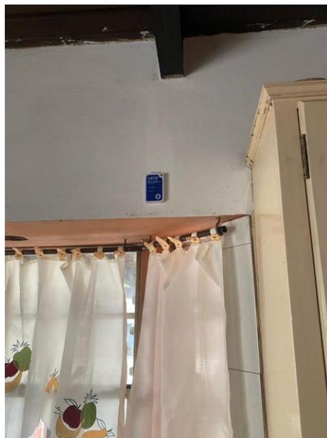
**Ilustración 21 - Sensor de temperatura instalado en pared sur interior en residencia construida con bloque de concreto (30 de octubre).**
