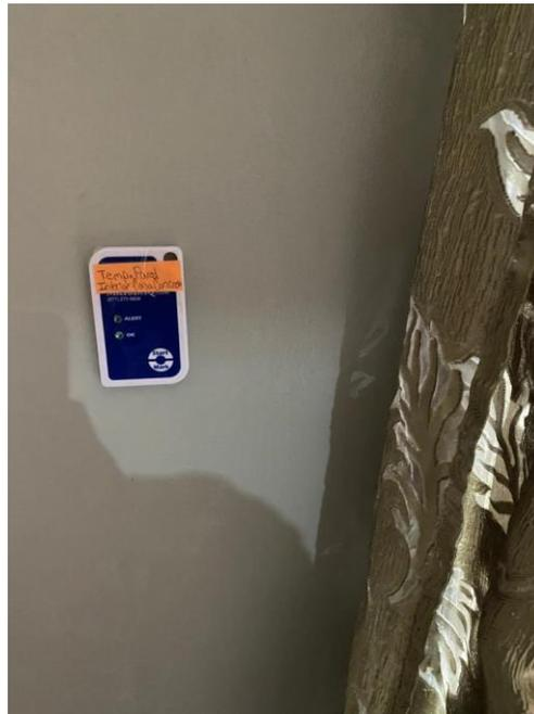
**Ilustración 29- Sensor de temperatura instalando en pared oeste interior de residencia construida con bloque de concreto (1 de noviembre).**
