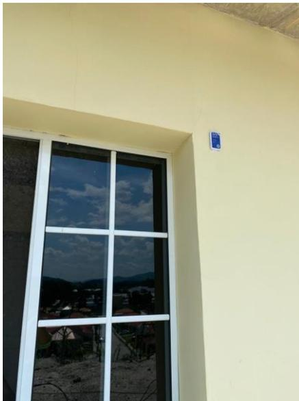
**Ilustración 19 - Sensor de temperatura instalando en pared sur exterior en la residencia construida con poliestireno expandido (30 de octubre).**
