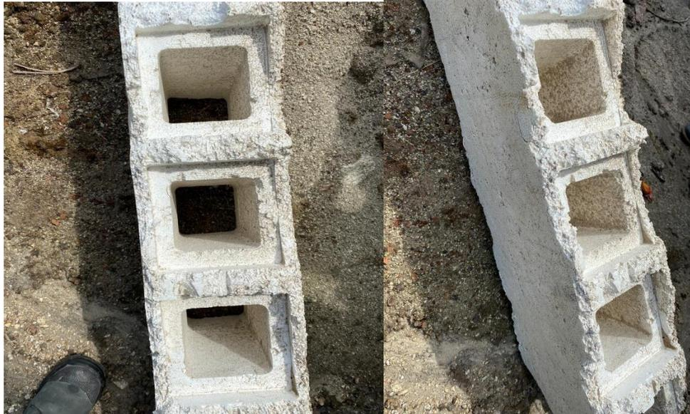
**Ilustración 7- Bloque de poliestireno sobrante en una construcción residencial**
