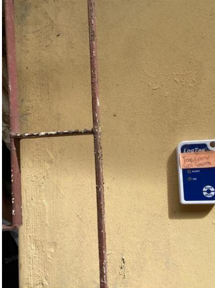
**Ilustración 30 - Sensor de temperatura instalando en pared oeste exterior de residencia construida con bloque de concreto (1 de noviembre).**
