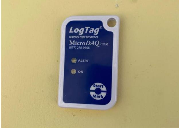
**Ilustración 10- Sensor de temperatura LogTag utilizado**
