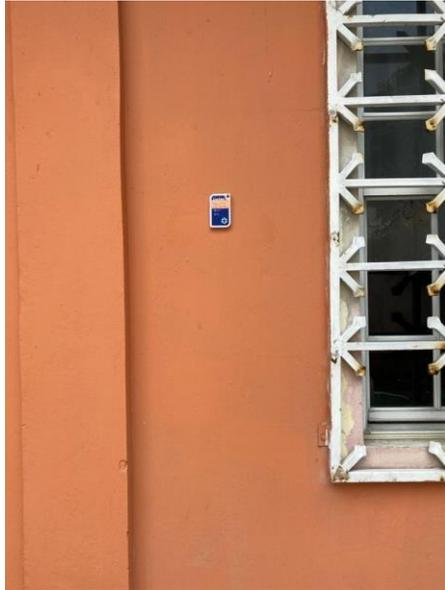
**Ilustración 26 - Sensor de temperatura instalando en pared este exterior en residencia construida con bloque de concreto (31 de octubre).**
