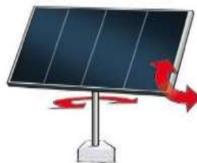
Ilustración 14-Movimientos del seguidor solar de dos ejes.
