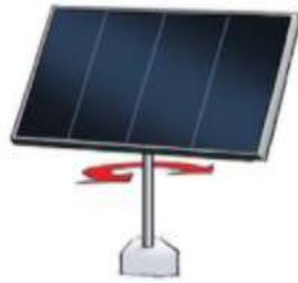
Ilustración 13-Eje de rotación del seguidor solar de un eje vertical.
