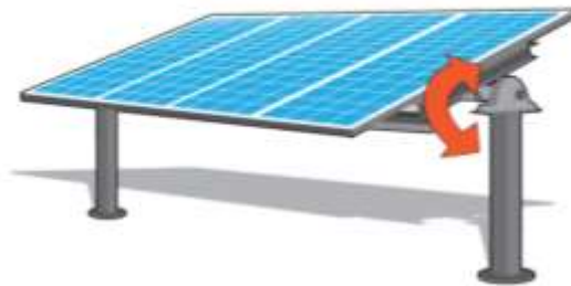
Ilustración 12-Eje de rotación del seguidor solar de un eje horizontal.
