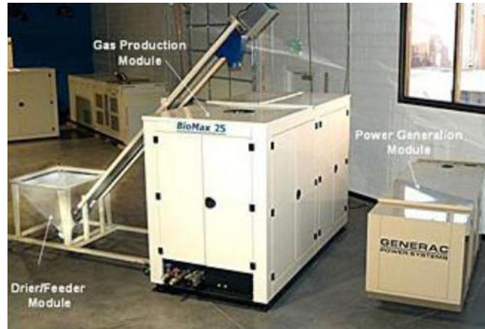
**Ilustración 4: Sistema de Gasificación BIOMAX 25**
