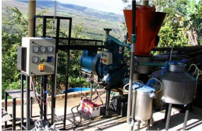
**Ilustración 5: Sistema de Gasificación FGB 20**
