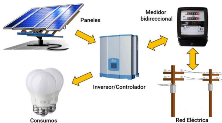
Ilustración 10 sistemas de conexión fotovoltaicos conectados a red
