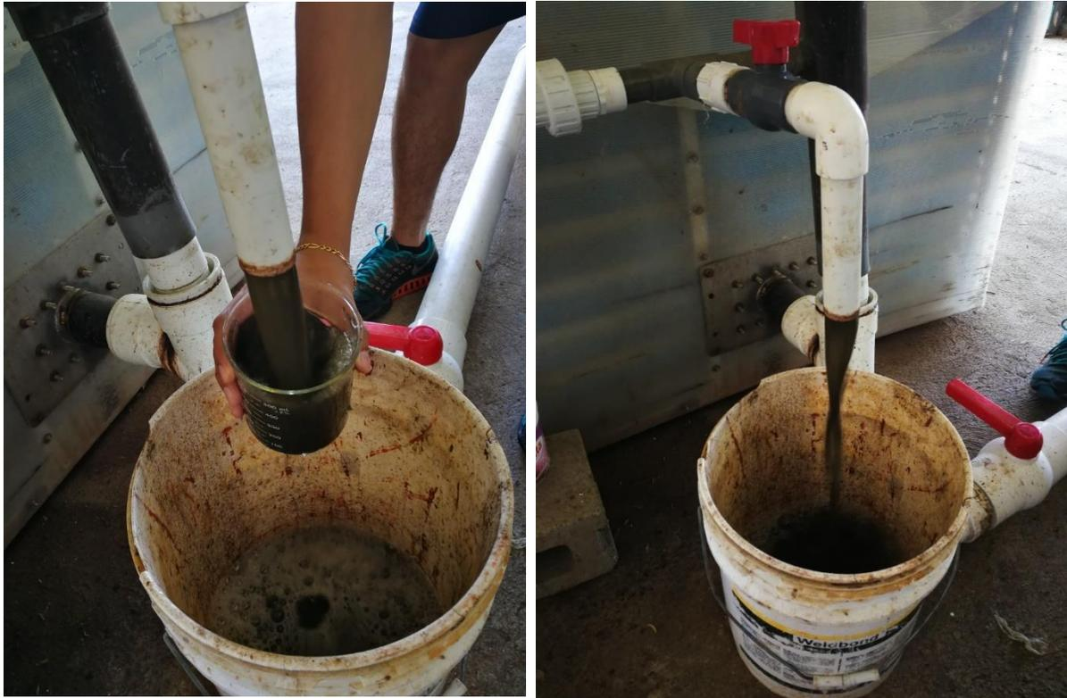
Ilustración 28: Recirculación del sustrato y análisis de muestra de pH
