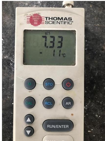
Ilustración 19: Medidor de pH
