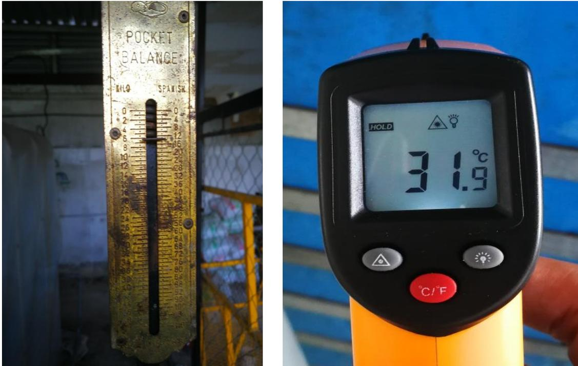
Ilustración 23: Balanza y pirómetro utilizados en la investigación
