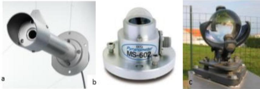
**Ilustración 3. Equipos de medición de radiación solar a)pirheliometro b)piranometro c)heliografano.**
