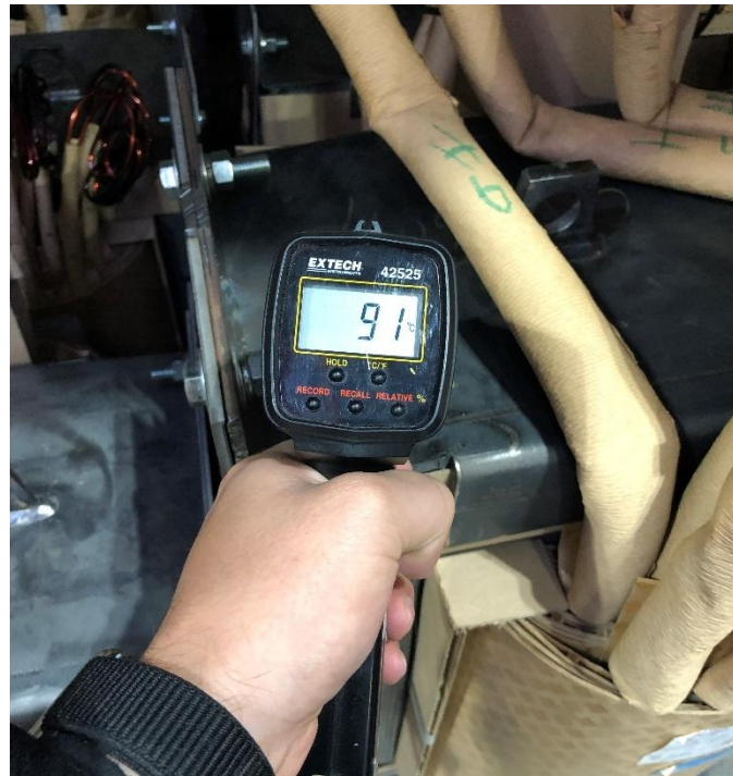
Ilustración 25: Temperatura de la parte activa 30 minutos después de apagar el horno.
