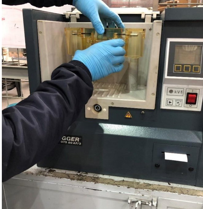
Ilustración 5: Instalación de la muestra de aceite.
