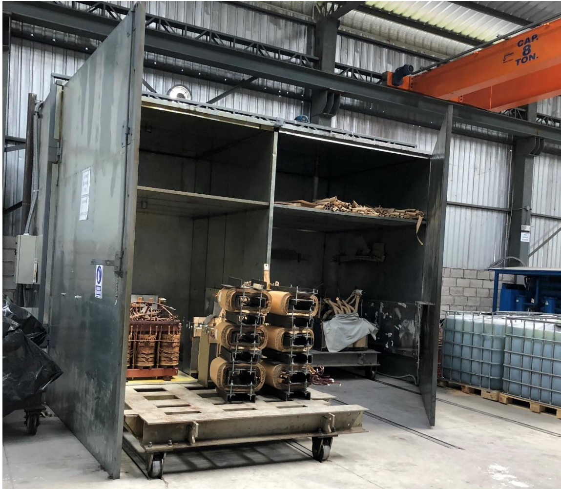
Ilustración 24: Horno para curado de bobinas y núcleos.
