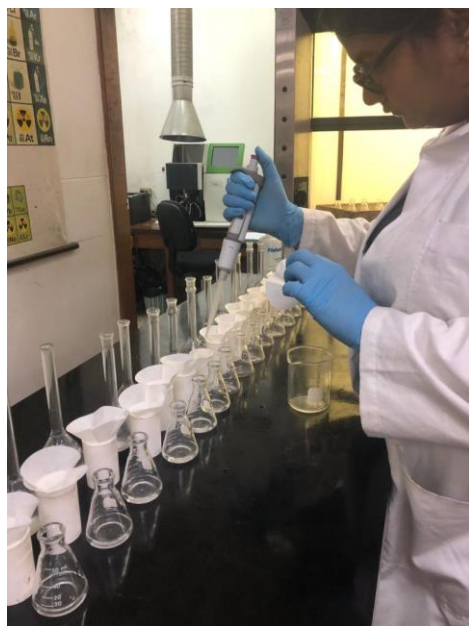
Ilustración 31: Se filtran las muestras para determinación de azufre.
