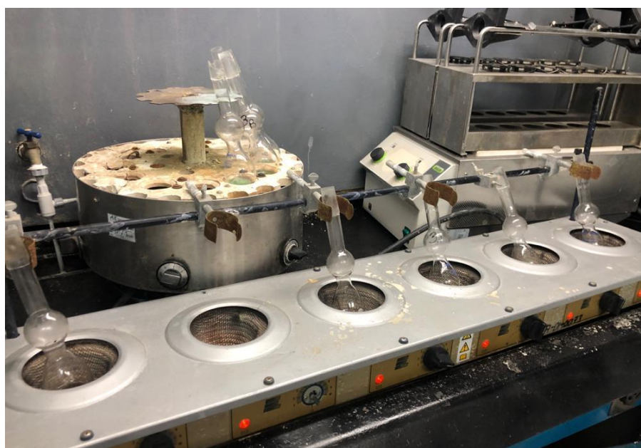
Ilustración 21: Quemando muestras en campana de gases.
