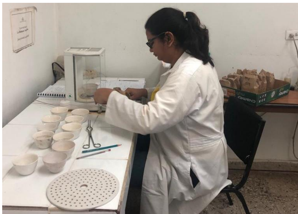
Ilustración 17: Pesaje de muestras para prueba de ceniza y carbon posterior a calcinación.
