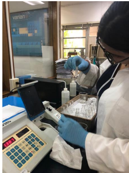
Ilustración 32: Se colocan la muestra en la celda de lectura del equipo.
