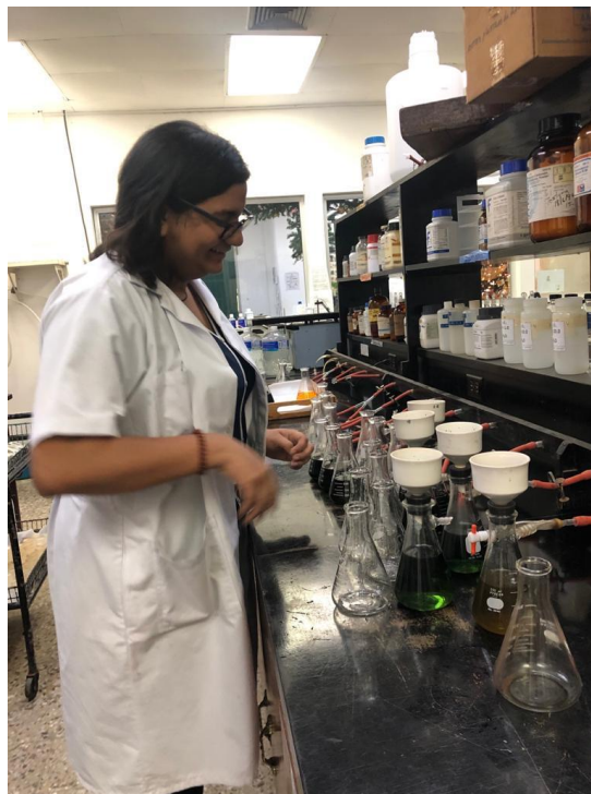
Ilustración 34: Filtración de muestras de materia orgánica.
