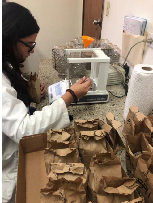
Ilustración 18: Peso de muestras para prueba de nitrógeno.
