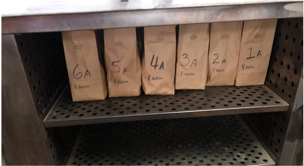
Ilustración 10: Secado de muestras en el horno.
