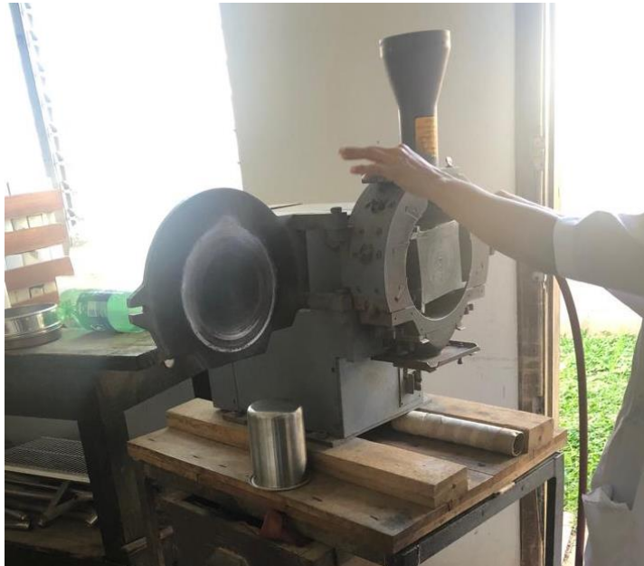
Ilustración 12: Molino willey para la trituración de las Muestras Secas.
