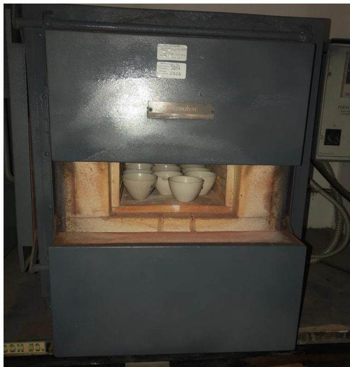
Ilustración 16: Muestras para porcentaje de cenizas y carbon dentro de la mufla.
