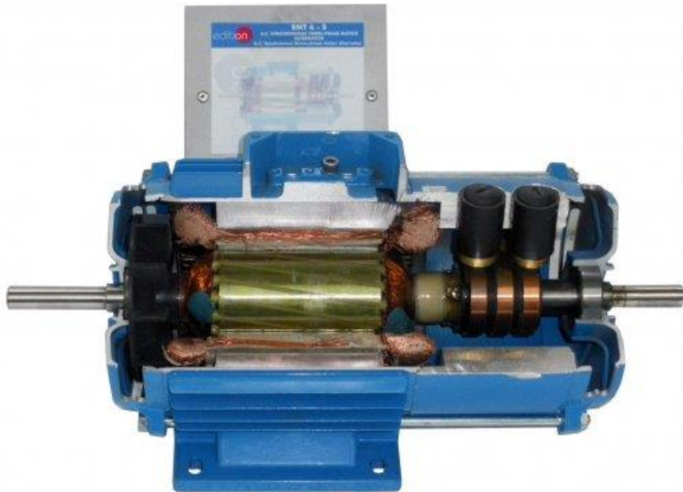
Ilustración 5 - Interior de motor síncrono
