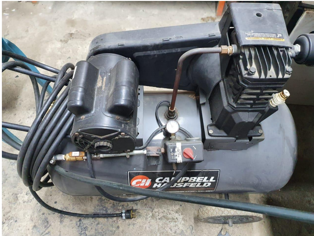
Ilustración 8 - Motor monofásico en compresor
