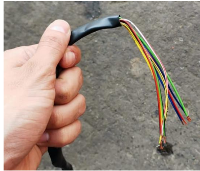
Ilustración 25: Cables de señal de los inyectores
