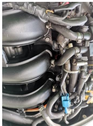
Ilustración 26: Colector de Admisión perforado
