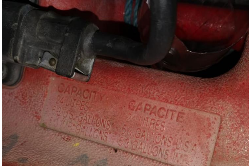
Ilustración 30: Capacidad Total del Tanque de Gasolina del Motor de la Lancha
