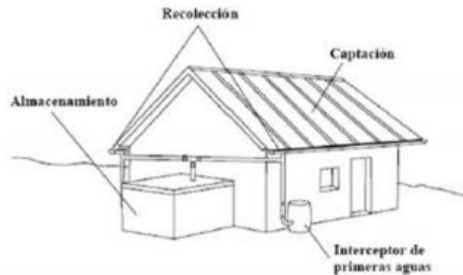
Ilustración 3.4 Diseño para captación de aguas.
