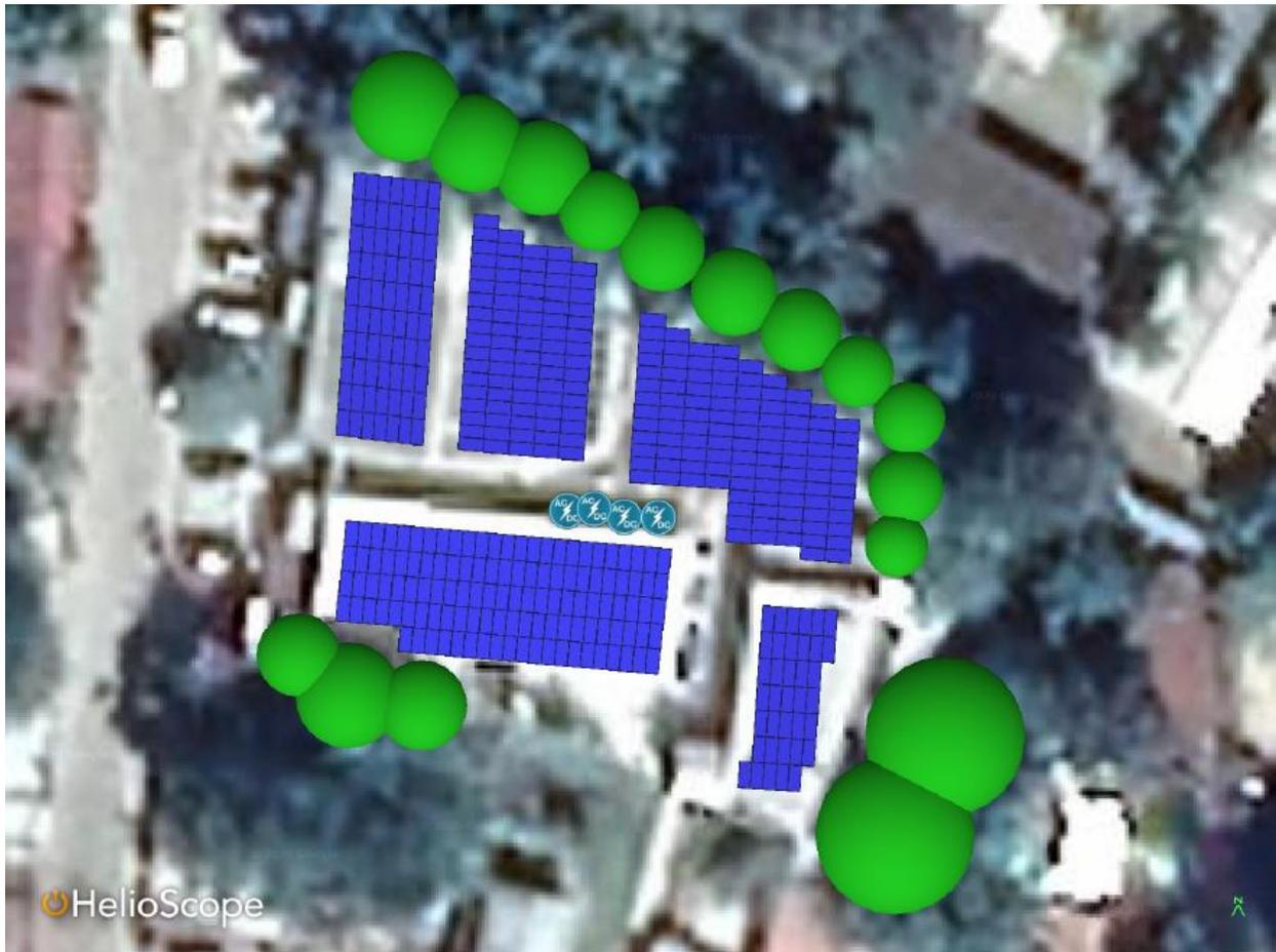
**Ilustración 31. Diseño del sistema solar sobre techo.**
