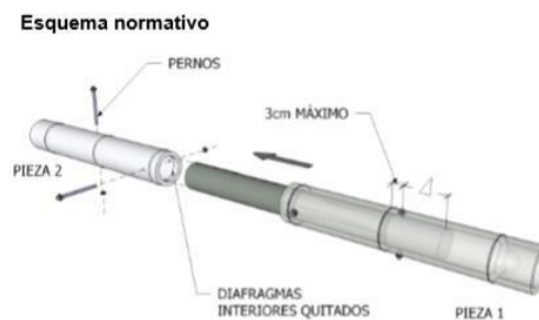
Ilustración 22: Esquema de uniones longitudinales
