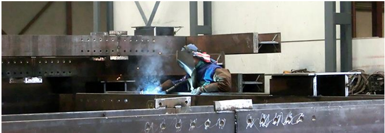
Ilustración 32: Fabricación de estructuras de acero en planta de Integralia
