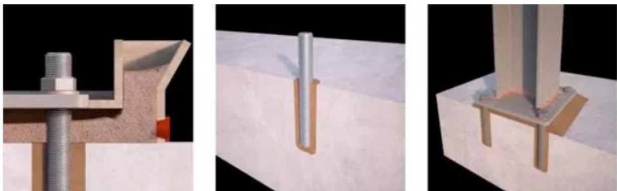
Ilustración 102: Funcionamiento del grout de nivelación en anclajes
