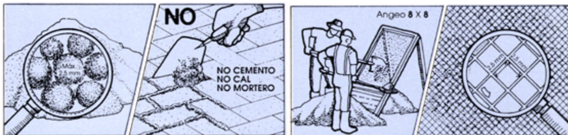
Ilustración 144. Sellado de las juntas en adoquín
