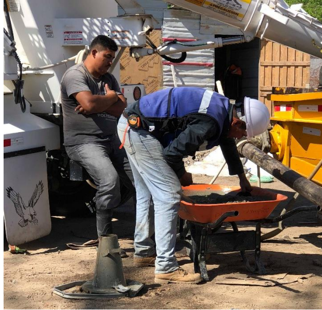
Ilustración 73. Proceso prueba de revenimiento
