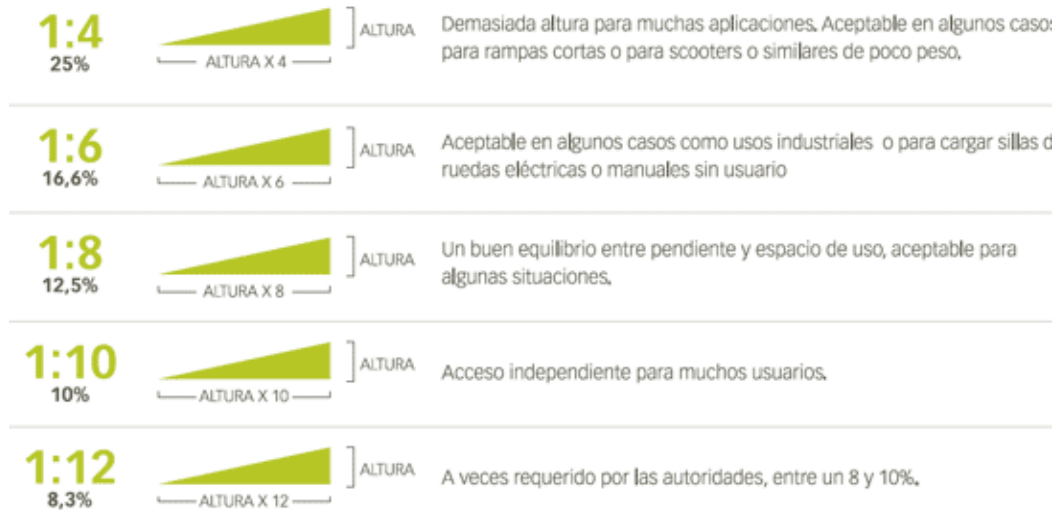
Ilustración 123. Desnivel rampas de acceso
