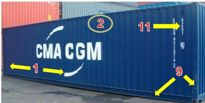
**Ilustración 23.** Revisión de paneles laterales de un contenedor
