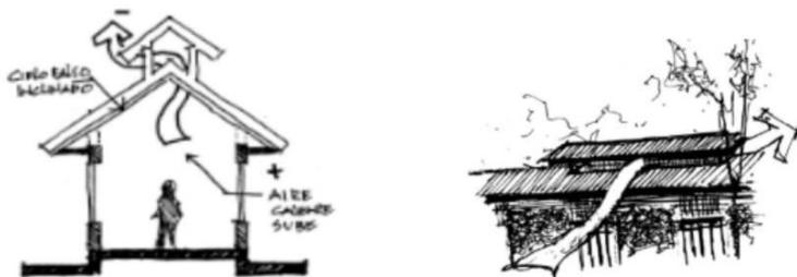
**Ilustración 59.** Cielo falso inclinado y abertura longitudinal
