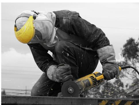
**Ilustración 36.** Amoladora en uso para el corte de contenedores
