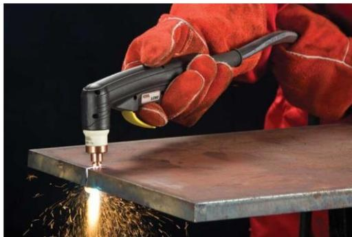
**Ilustración 37.** Cortadora de plasma para cortar contenedores
