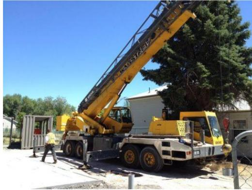
**Ilustración 39.** Grúa para levantamiento de contenedores
