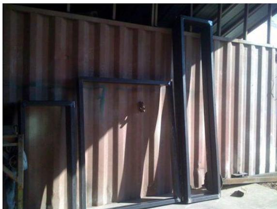
**Ilustración 50.** Marcos de puertas y ventanas para ensamblar
