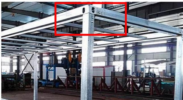
**Ilustración 14.** Marco del contenedor con sus uniones
