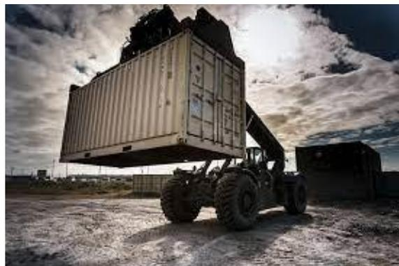
**Ilustración 40.** Montacargas para levantamiento de contenedores
