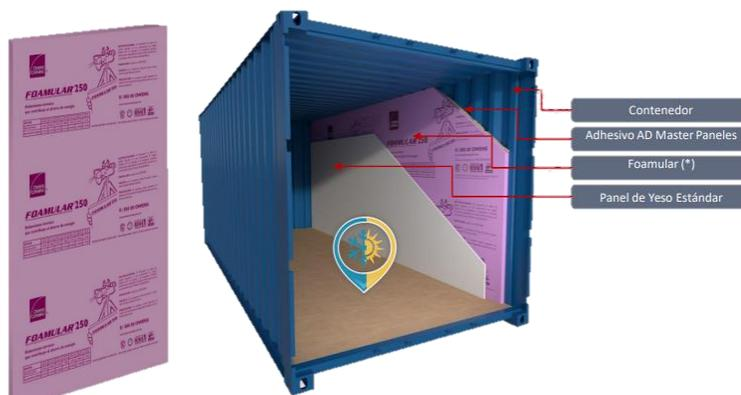
**Ilustración 92.** Foamular 250 en muros, Owens Corning
