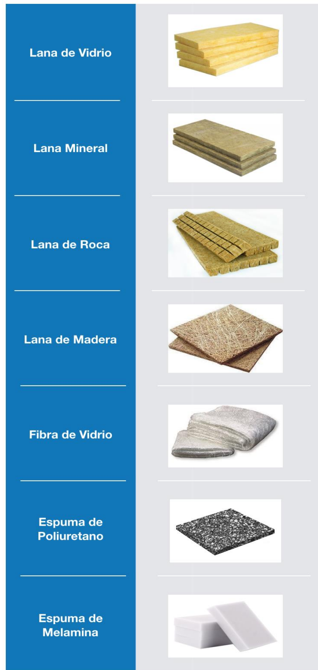
Ilustración 39. Materiales utilizados para absorber el sonido
