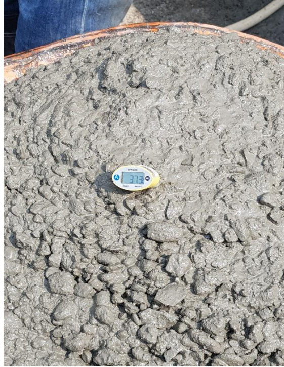
Ilustración 29: Pruebas de temperaturas del concreto.
