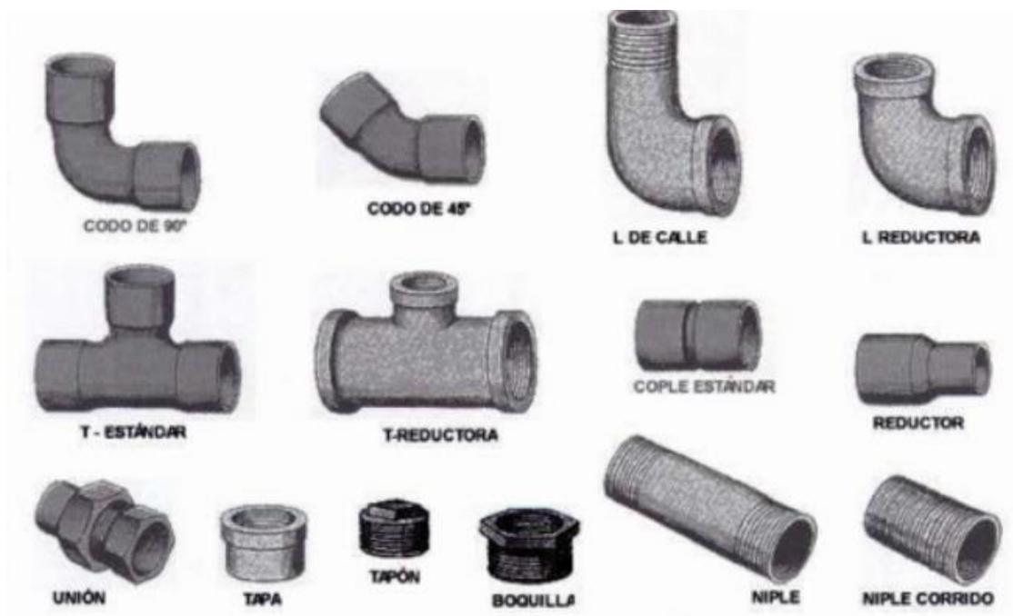
**Ilustración 17 Accesorios para instalaciones hidráulicas y sanitarias**
