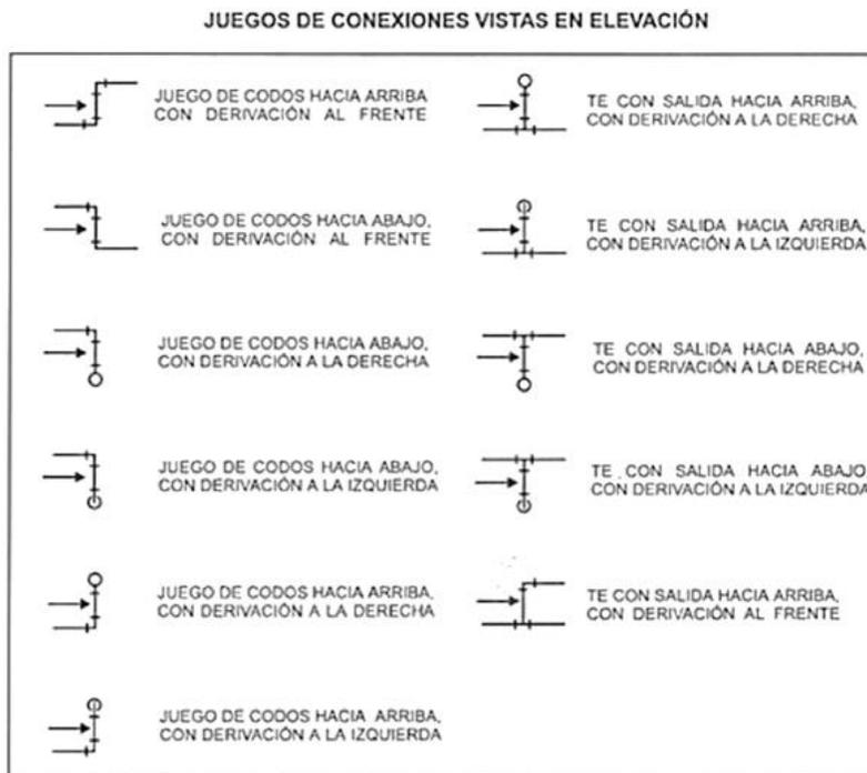
**Ilustración 49 Juego de conexiones vistas en elevación**
