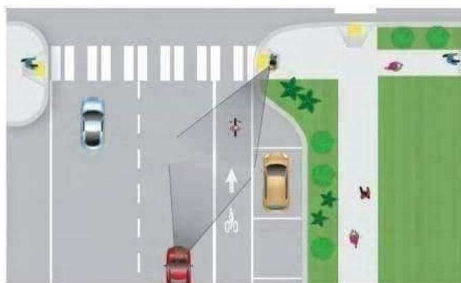
**Ilustración 22. Visual óptima de conductor hacia paso peatonal.**
