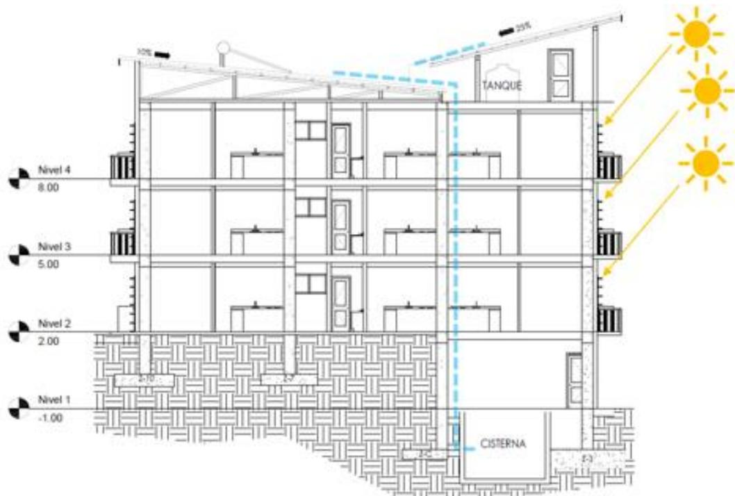
**Ilustración 65. Reciclaje de Aguas Lluvia y Protección Solar**
