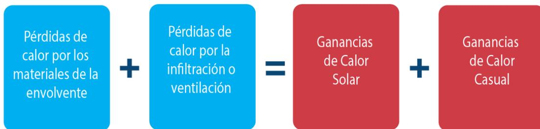
*Ilustración 48: Esquema de ganancias y pérdidas de calor en Edificaciones.*
