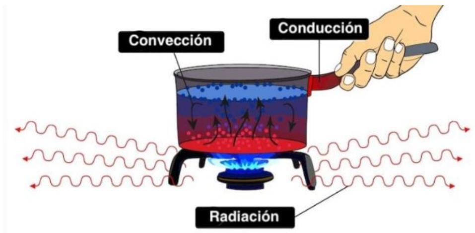
Ilustración 58: Transferencias de calor.
