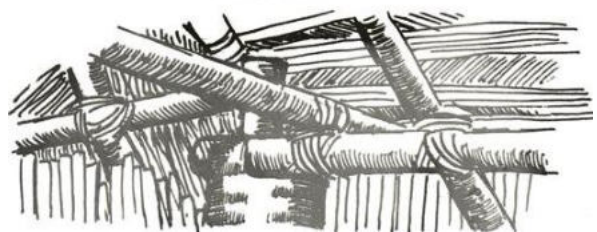
Figura 5. Detalle de intersección de viga y horcón.
