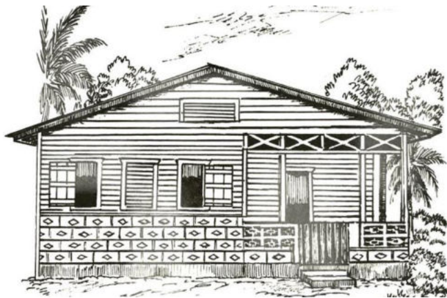
Ilustración 8 Construcción Garífuna de Yagua y bloque Fuente: (Salinas, 2002)
