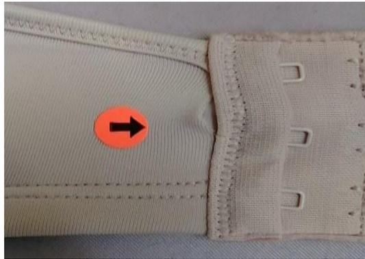
**Figura 13. Fotografía defecto de costura abierta en operación 91 (pegado de broche).**
