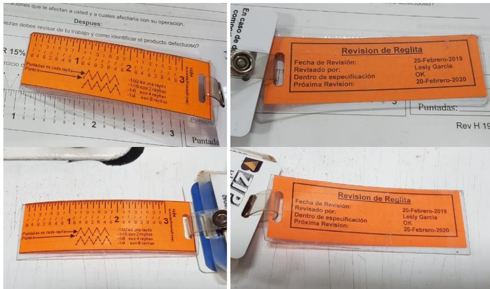
**Figura 63. Verificación de reglas de medición asignadas a operadores estilo DF3372.**
