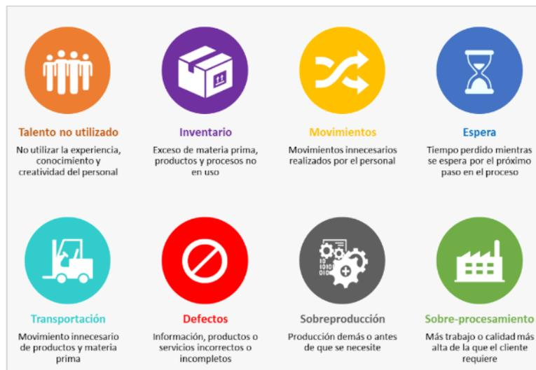
**Figura 7. Los 8 desperdicios de la manufactura esbelta.**
