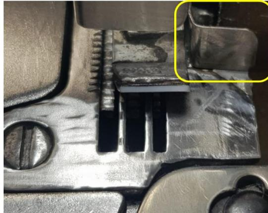
**Figura 71. Pokayoke de guía metálica para operaciones de costura.**
