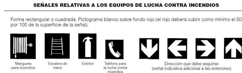
Figura 2: Señales Equipo Contra Incendios
